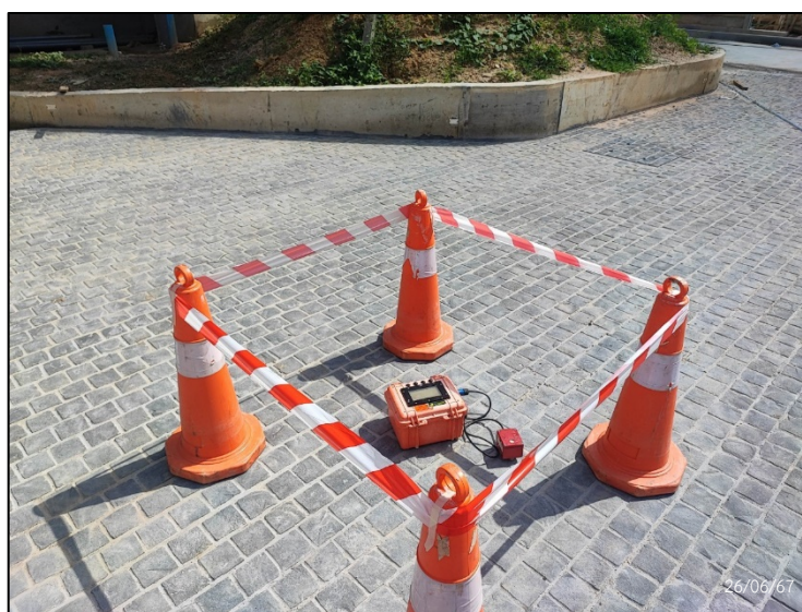
รูปที่ 4.3.3-1 ตัวอย่างแสดงการตรวจวัดความสั่นสะเทือน
